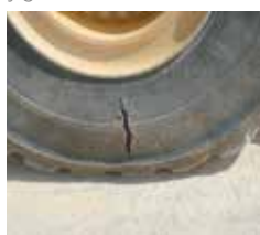
Reparación de rasgadura y grieta
