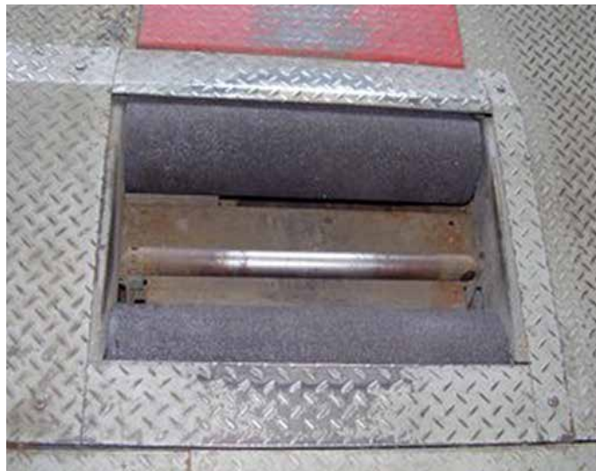
Rodillos de accionamiento: 12 años después de la aplicación original, aún en excelentes condiciones
